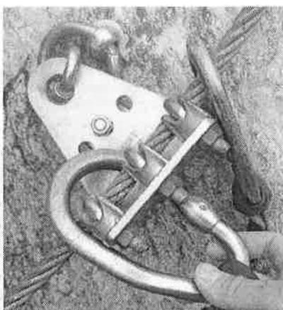
ejecutados con chapa de acero galvanizado de 4 mm de espesor. Deben contar con el correspondiente ensayo que garantice su resistencia a la rotura superior a los 4.015 kg indicados (Ver anexo V)
